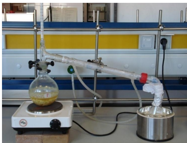
Figura 5. Montaje de extracción por hidrodestilación (Foto: Galvis, V. E.)
