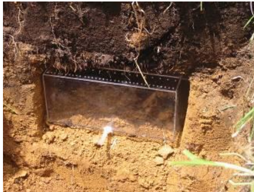
Figura 8. Instalación de lisímetro debajo del horizonte A
