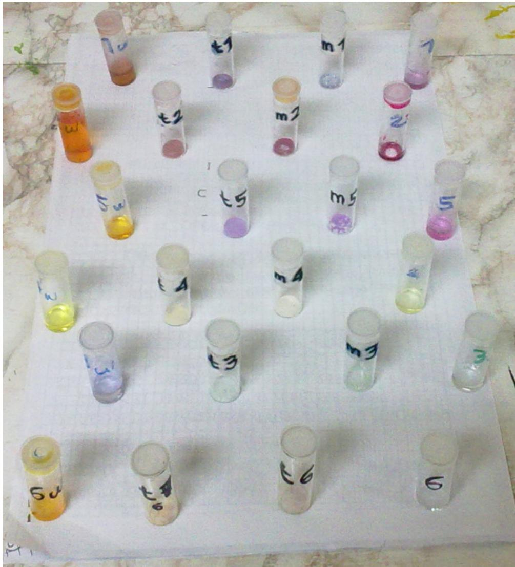
**Figura 4.17** Pruebas de acidez de las circonias sulfatadas sintetizadas en este trabajo
