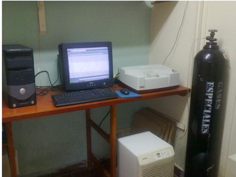
**Figura 3.1** Espectrofotómetro IR-FT
