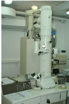
**Figura 3.2** Microscopio Electrónico de Transmisión
