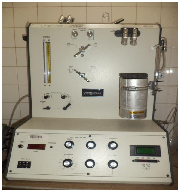
Figura 3.3. Equipo Quantachrome Chembet 3000 (BET)
