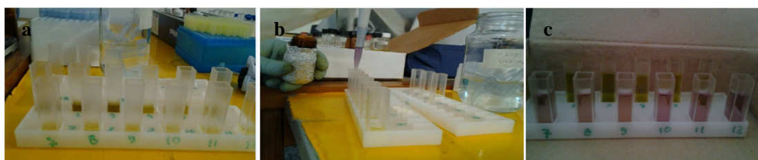
Figura 15. Análisis de AAO por el método del DPPH. a) Toma de muestras, b) Adición del radical DPPH * , c) Incubación de muestras
