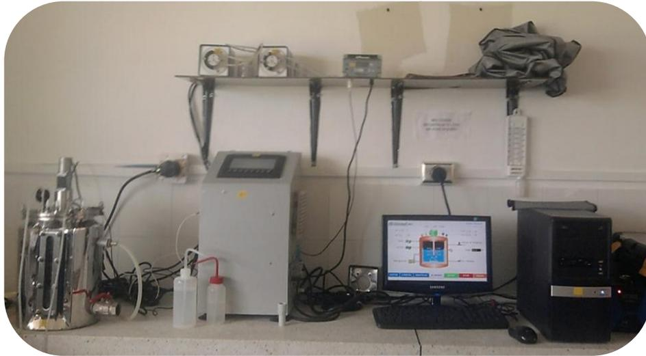
**Figura 4.** Bioreactor usado para la Hidrólisis enzimática.
