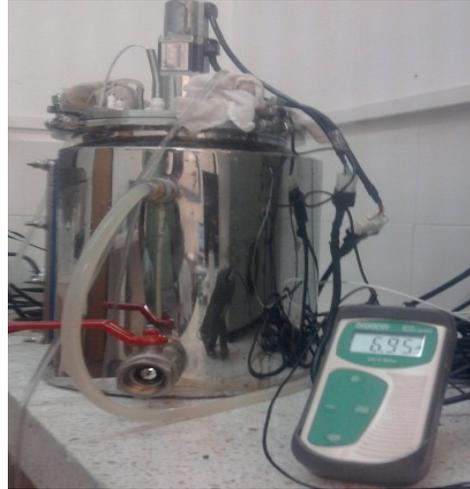
2. Bioreactor usado para la hidrólisis enzimática.
