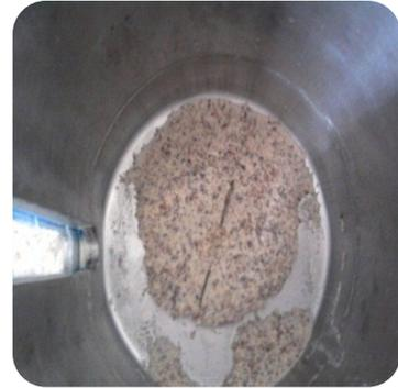
**Figura 11.** Residuo sólido de la hidrólisis.
