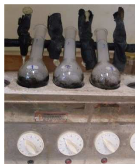
Figura 53. Digestión de la muestra para la determinación de proteína por el método Kjeldahl
