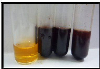
Figura 44. Resultado colorimétrico de la prueba de hidroxilamina para el triplicado del experimento 4B.
