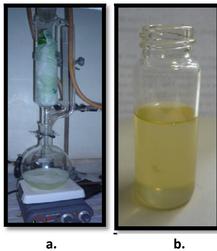
Figura 21. a) Proceso de extracción del aceite por medio del Método Soxhlet. b) Muestra de aceite extraído
