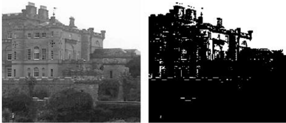
Figura 5. Efecto de la cuantificación en la transformación de una imagen a blanco y negro
