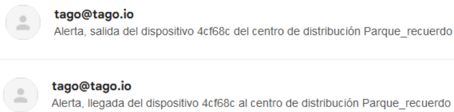
Figura 3.6. Notificaciones en correo electrónico de ingreso y salida del centro de distribución para el dispositivo Loka 2.
