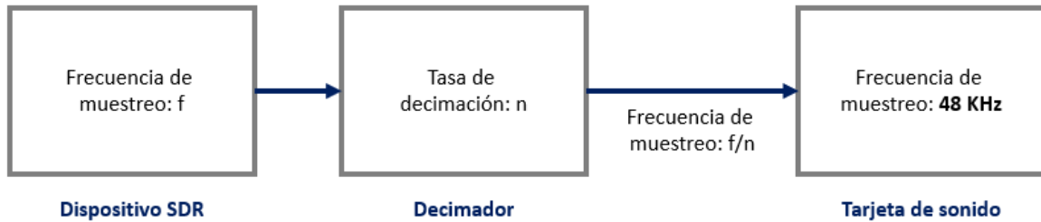
Figura 29. Proceso de decimación para el prototipo analizador de espectro. Fuente: Elaboración propia.
