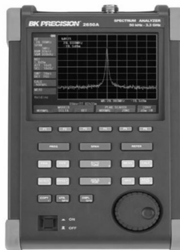
Figura 21. B&K Precision 2650A, Analizador de Espectro Portátil. 50 kHz a 3.3 GHz. Fuente: Tomada de [49].
