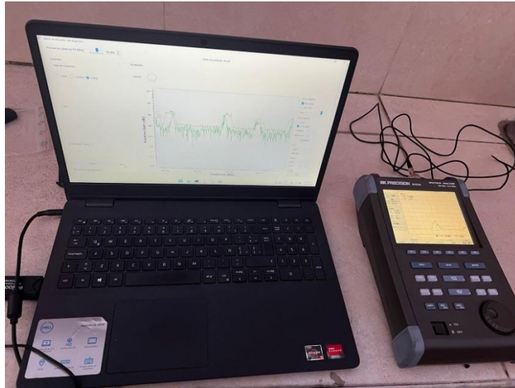
Figura 42. Montaje físico para la calibración del prototipo analizador de espectro.
