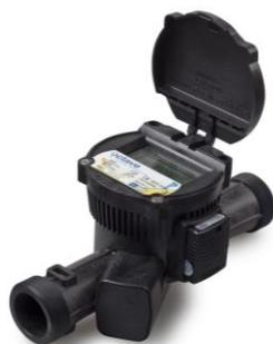
Es un medidor de agua ultrasónico, basado en el principio del tiempo de tránsito, que no requiere elementos o partes móviles. Este medidor es utilizado principalmente en soluciones de macro medición para las redes de abastecimiento de agua o para uso industrial. Uno de sus requerimientos de instalación es que el medidor debe estar completamente lleno para un correcto funcionamiento. El medidor está disponible en: DN50 y DN300 con cuerpo de hierro fundido; DN40 y
