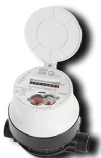
Es un medidor volumétrico de pistón rotativo, fabricado y comercializado por la empresa Janz, y diseñado para superar condiciones exigentes, como por ejemplo, medición de agua con sólidos en suspensión, ya que dispone de un pistón ranurado. Permite la integración con sensores MyWater o emisores de pulso de tipo inductivo, debido a que el JV600 está equipado con una salida de pulsos, donde cada pulso generado equivale a 1 litro de agua medido [86].
