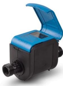
Es un medidor ultrasónico de alta precisión y confiabilidad para la medición de agua potable en aplicaciones residenciales. Este medidor es diseñado, producido y comercializado por la empresa israelí Arad Group. No tiene piezas móviles y gracias a su diseño no requiere de mantenimiento. Es insensible a arena y partículas en el agua, permite la medición de flujo bidireccional, además se cuenta con dos versiones: Sonata20 con DN20 y Sonata25 con DN25 [87].
