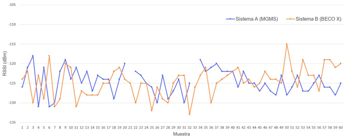
Figura 4.23. Valores de RSSI en pruebas posteriores de los sistemas A y B.
