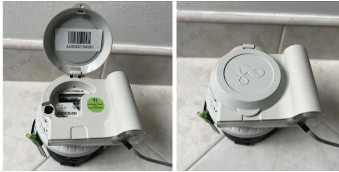
Figura 3.38. Integración medidor Altair y emisor de pulsos.
