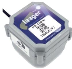
Definido como un módulo desarrollado y fabricado por la empresa Laager de Brasil para la lectura y transmisión de información de medidores de agua, gas y energía. Tiene compatibilidad con la zona RC2 y RC4 de Sigfox, y cuenta con una batería de litio con una vida útil de aproximadamente 8 años, la
