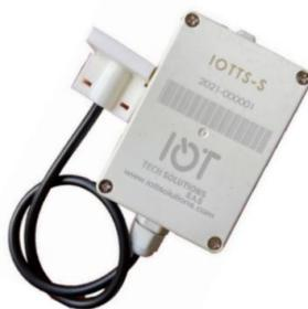
Es un módulo de comunicación producido por la empresa IoT Tech Solutions y es utilizado para transmitir información de medidores de gas o agua de tipo domiciliario y puede ser adaptado a diversos tipos de medidores que cuenten con salida de pulsos. Maneja la detección de pulsos a través de un sensor de efecto
