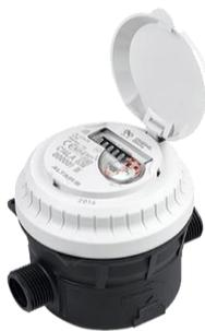
Es un medidor volumétrico de pistón rotativo diseñado y fabricado por la empresa Diehl Metering. Cuenta con un diseño compacto y una medición precisa, siendo compatible con distintas calidades de agua. Se puede encontrar en las siguientes referencias relacionadas con su tamaño (Diámetro Nominal<sup>13</sup>): DN15 y DN20. Este medidor puede integrarse con un módulo emisor de pulsos IZAR del mismo fabricante para el proceso de telelectura [84].
