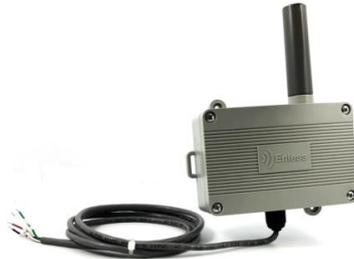
Es un transmisor de medición producido por la empresa francesa Enless Wireless. Este dispositivo opera en la zona RC4 definida por Sigfox con una potencia de 22 dBm y es compatible con medidores de agua y energía. Este módulo cuenta con una batería reemplazable de litio tipo D, sus dimensiones en milímetros son: 118 x 43 x 79, y tiene protección IP65 [96].
