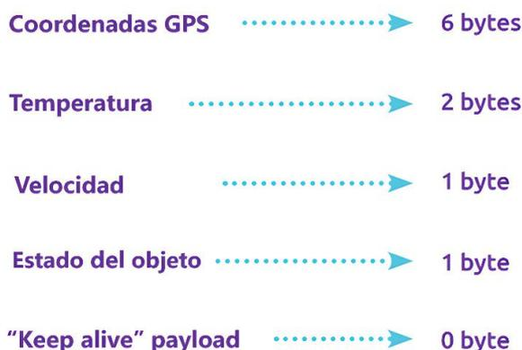
Figura 1.6. Ejemplos de tamaños de carga útil en Sigfox. Tomada y adaptada de [36].
