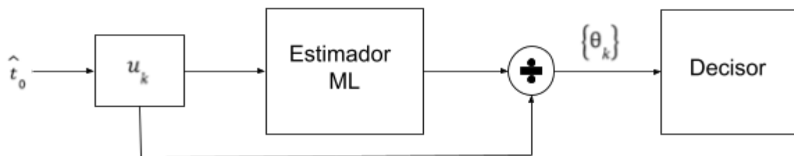
Figura 2.20 Diagrama de bloques sincronismo de portadora.
