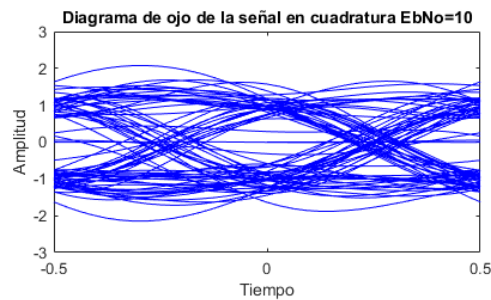
Figura 2.6 Diagramas de Ojo 4-QAM.
