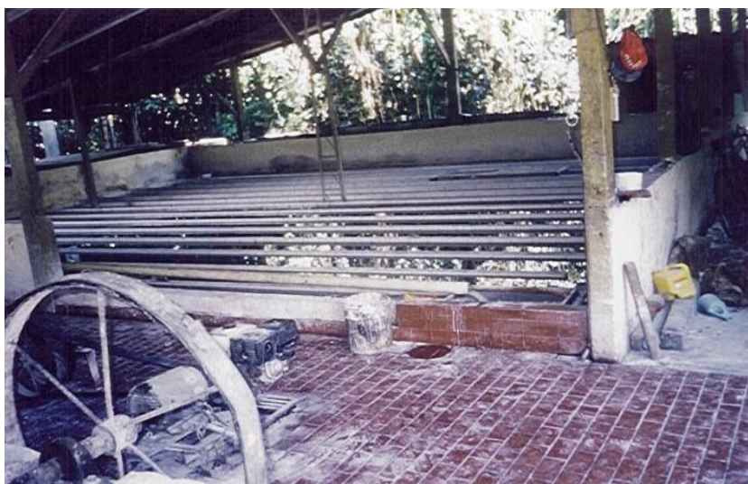
Figura 2. Canales de sedimentación del almidón de yuca.
