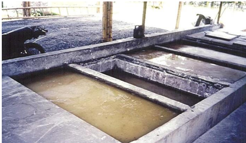
Figura 3. Tanques de fermentación del almidón de yuca.
