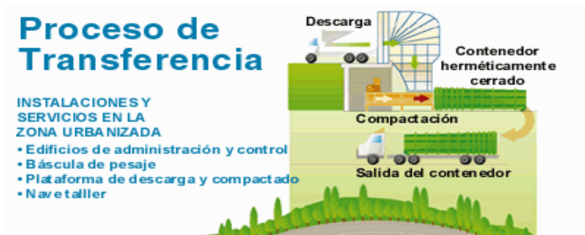
Figura 8. Proceso de transferencia de R.S.U.
