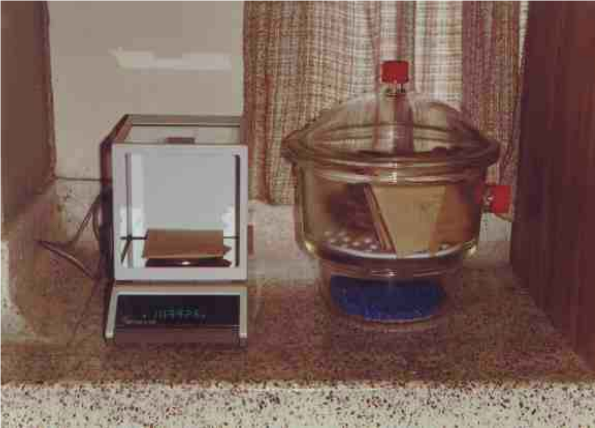
Fotografía 17. Determinación del peso seco, laboratorio de la Universidad del Cauca
