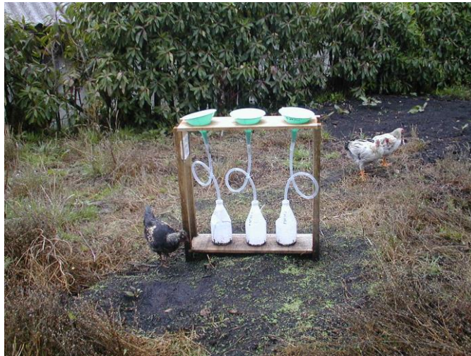
Figura 15. Montaje de colectores de precipitación en campo.
