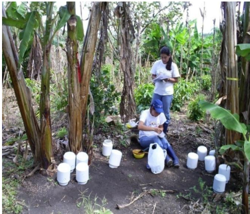
Figura 3. Recipientes de vidrio con el NaOH cubiertos con los recipientes plásticos a las dos distancias establecidas (10-40 cm).
