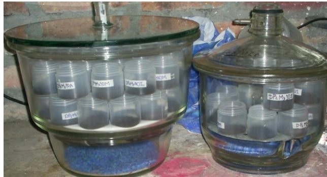
Figura 6. Muestras denominadas fumigadas en el desecador para el desarrollo de biomasa
