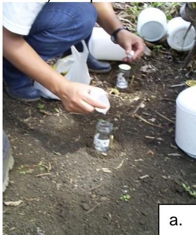
Figura 4. 24 Horas después del montaje: a) Adición de cloruro de bario en el sitio de muestreo. b) Recipiente de vidrio con cloruro de bario
