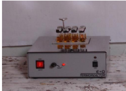
Figura 8. Muestras en el bloque de digestión a 150^\circ C
