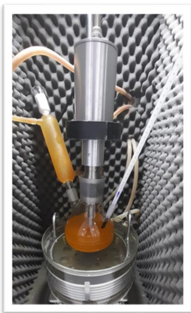
Imagen 3. Montaje de extracción de aceite de pulpa de B.gasipaes asistida con sonda ultrasonido (USAE).
