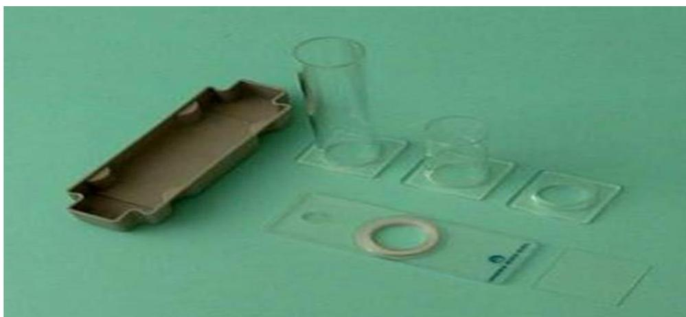
**Figura 5. Cámara de sedimentación implementada en la metodología Utermöhl para la determinación de la abundancia y composición fitoplanctónicas.**
