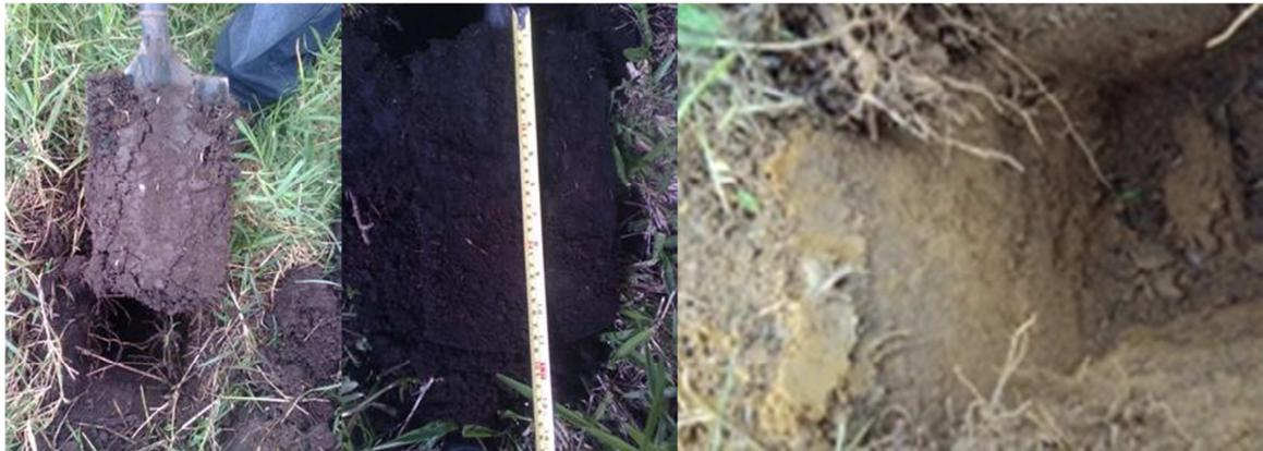
**Medición de la profundidad del horizonte superficial.** Se midió la profundidad del horizonte superficial, observando los cambios de color, descendiendo desde la superficie, a lo largo del perfil (ver figura 17).
