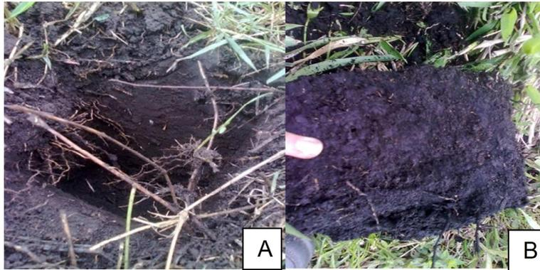
**Determinación de la resistencia.** Se usó una varilla metálica para chequear una de las paredes laterales, desde la superficie hasta el fondo. Se determinaron los cambios o diferencias en resistencia a la penetración.
