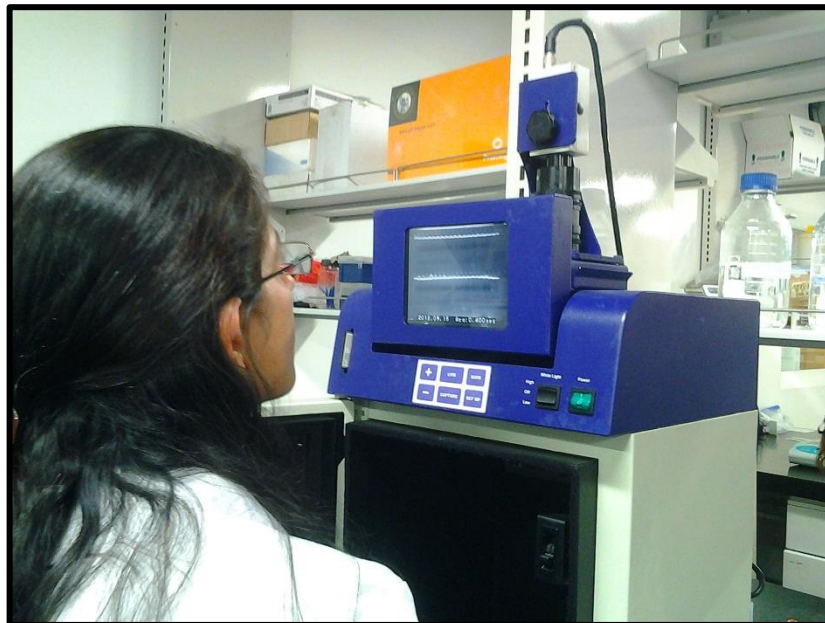
Fotografía 4. Vista del equipo: transiluminador de luz ultra violeta (LUV).
