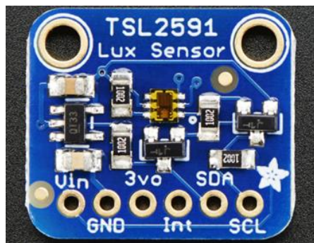
Figura 18. Sensor de Luz TSL2591.
