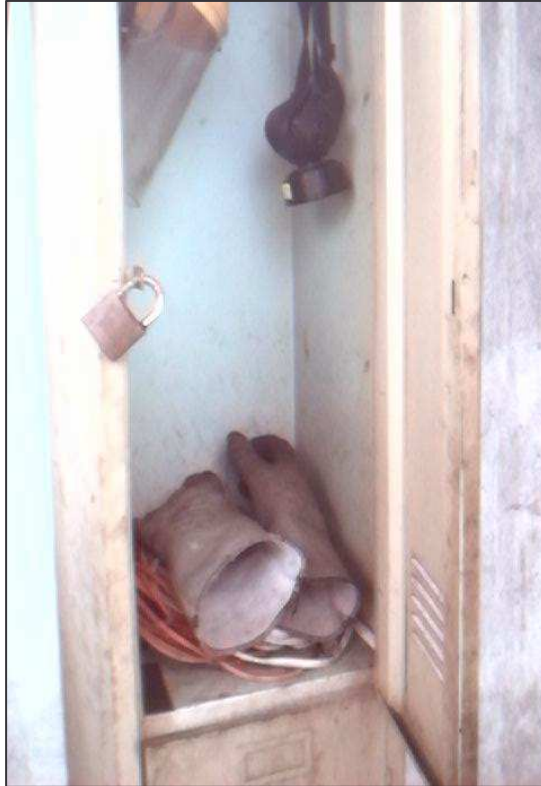
Figura 58. Falta de dotación adecuada e higiénica para el personal de encargado del proceso de incineración
