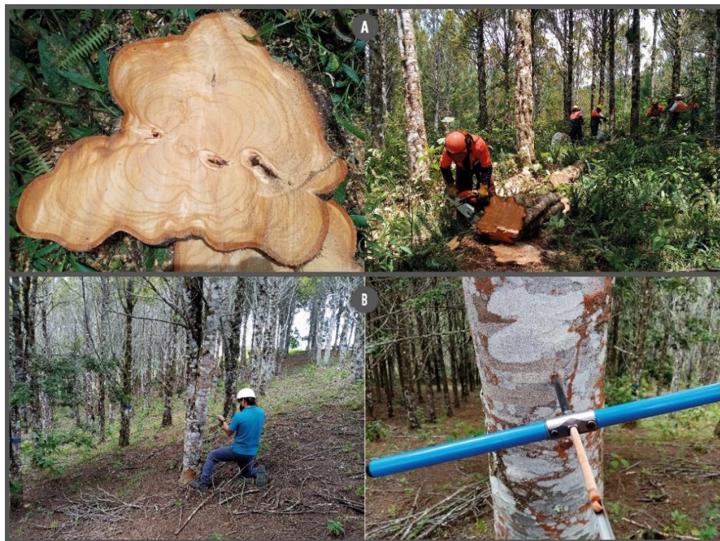
Figura 3. Extracción de muestras: A. Sección transversal, B. Núcleos.
