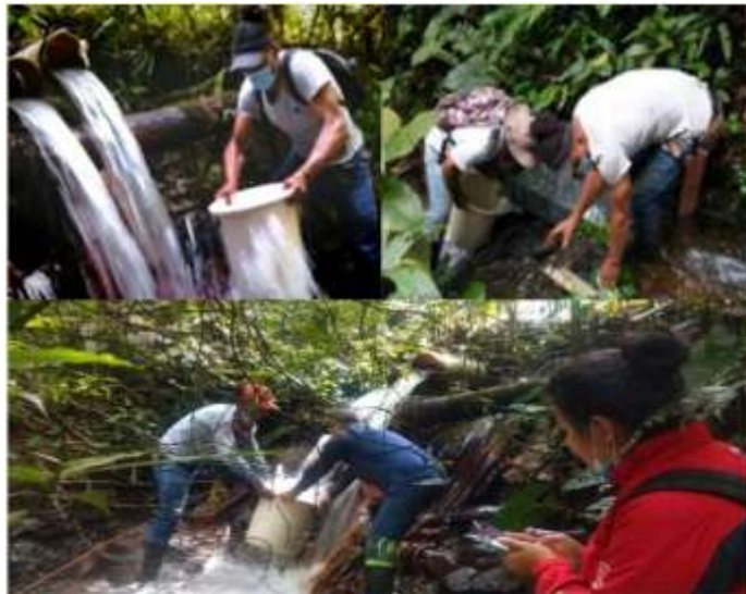
Figura 7. Medición de caudal de las diferentes fuentes hídricas presentes en los predios destinados para la RNSC Los Juanitos.
