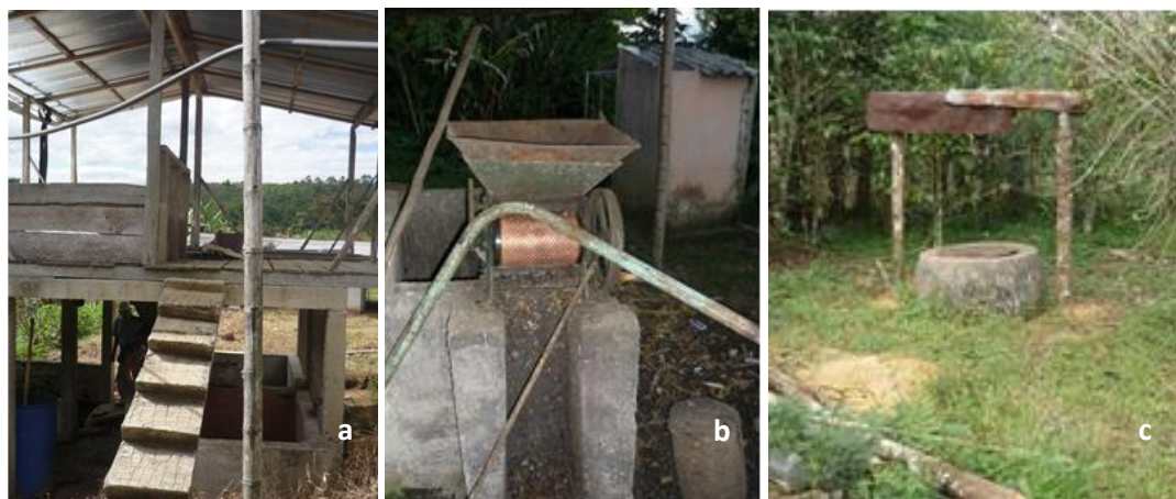
Figura 5. Ausencia de señalización. a) Gradas sin guardamanos; b) Despulpadora sin protección; c) Aljibe sin señalización
