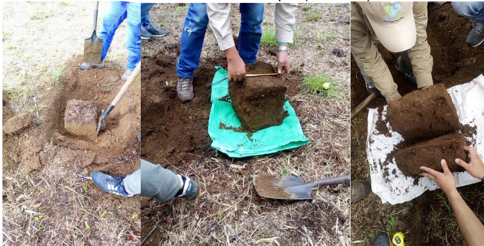
Figura 9. Muestreo de macrofauna mediante bloque (monolito)
