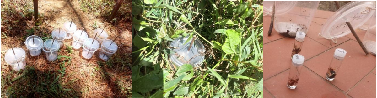
Figura 10. Caracterización de macrofauna mediante trampas de caída tipo Pitfall
