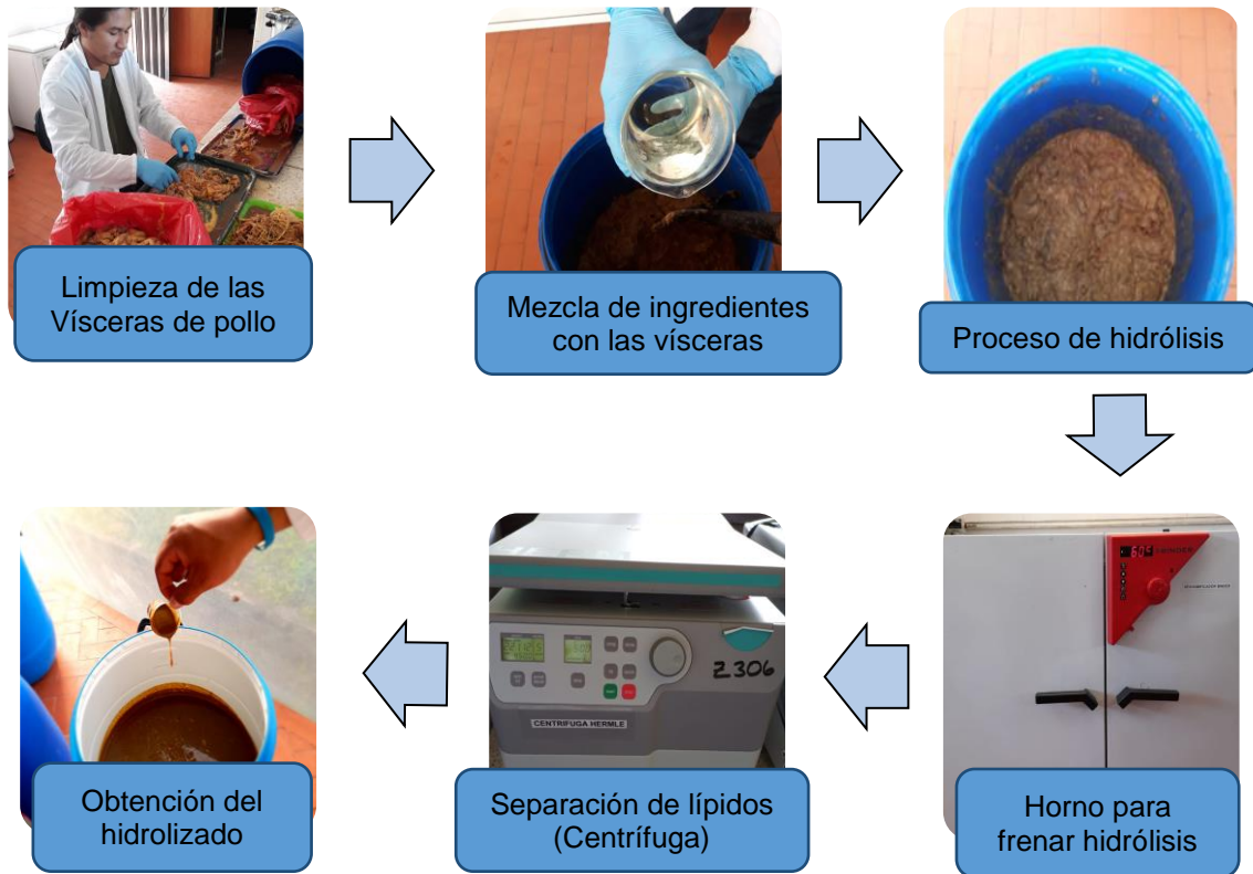
Figura 2. Elaboración del hidrolizado enzimático de vísceras de pollo
