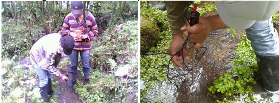
Figura 5. Aforo de aguas con molinete en el predio “El salado”
