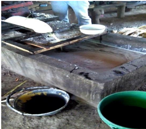
Figura 13. Inconformidad en el material del tanque de recolección del jugo
