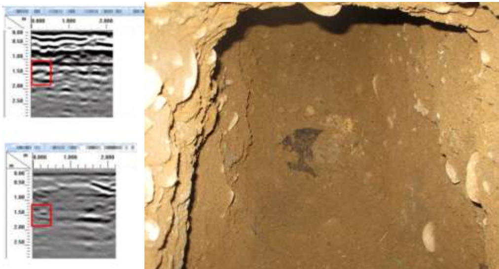
Ilustración 4.28. Uso de radargrama para localización de filtro en obra.
