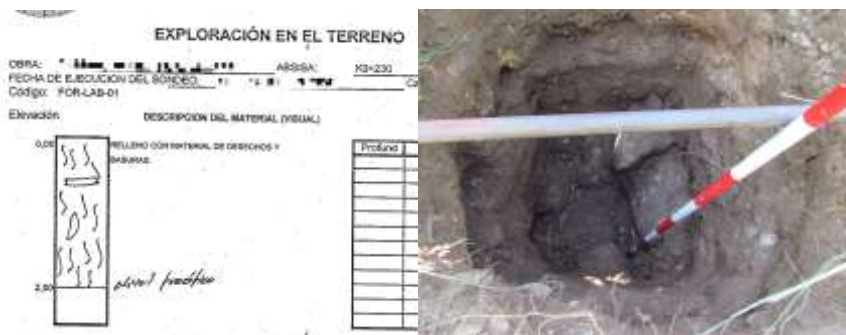
Ilustración 4.21. Apique en terreno aledaño.
