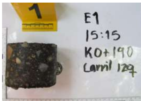
Ilustración 4.26. Núcleo extraído en obra
