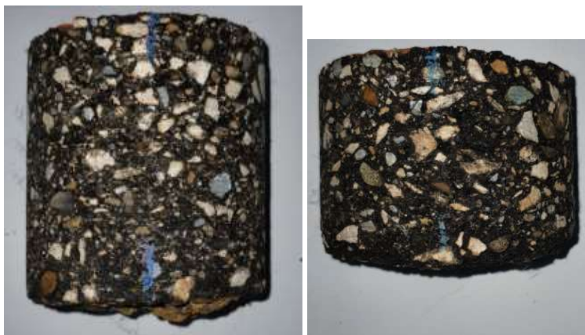
Ilustración 4.15. Variación en espesores de núcleos.
