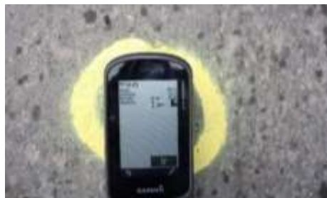
Ilustración 4.9. Referenciación de puntos por GPS
