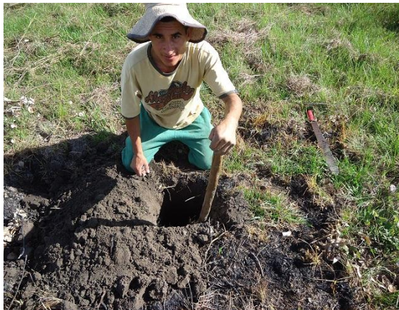
Figura 3. Construcción de calicata para análisis físico del suelo en diferentes lotes preseleccionados
