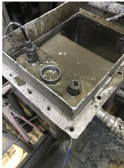
Figura 3.2: Punto de muestreo pH jugo encalado Fuente: Elaboración Propia (Lazo P&ID).
