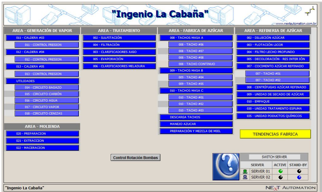
Figura 3.11: Pantalla inicial SCADA Ingenio La Cabana Fuente: Tomado de cuarto de ingeniería La Cabaña S.A
