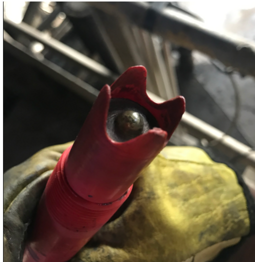
Figura 3.14: Electrodo Lazo de control pH amortiguado. Fuente: Estación de ingeniera.
