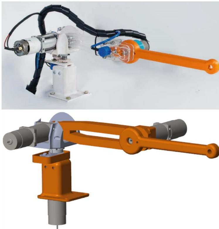
**Figura 4.25.** Evidencia de la comparación de la simulación frente a la implementación física en posición Home.
