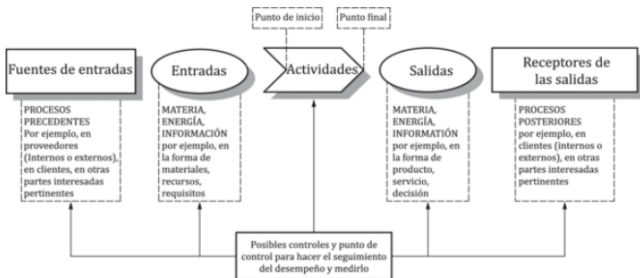
Ilustración 5. Representación esquemática de los elementos de un proceso. INSTITUTO COLOMBIANO DE NORMALIZACIÓN Y CERTIFICACIÓN. Sistema de gestión de la calidad: requisitos. NTC-ISO 9001:2015. Bogotá D.C.: El Instituto, 2015.
