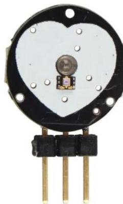
Figura 21. Sensor de Frecuencia Cardíaca [66]
