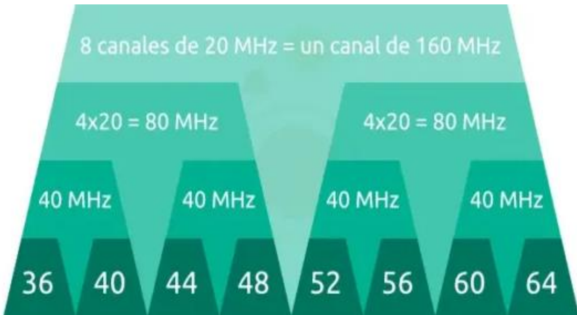
Figura 2.6 Canales Wi-Fi Banda 5GHz [14]
