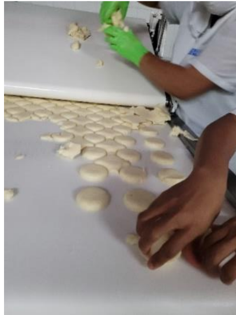
Figura 7. Elaboración de arepas por laminadora
