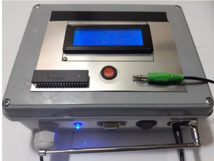
Figura D.3. Transmisor FM construido. Fuente: por autor.
