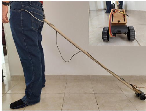
Figura 3.2: Dispositivo de medición de velocidad de marcha sujetado al usuario.
