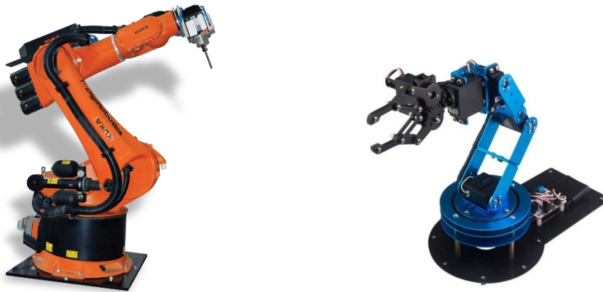
Figura 2. Robot industrial KUKA empleado en procesos de manufactura con controlador PLC (izquierda). Brazo robótico de carácter académico con controlador Arduino (derecha).
