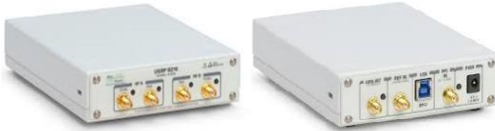
Ilustración 11. Vista frontal y posterior USRP B210
