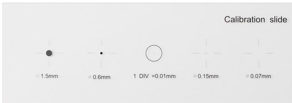
Figura 14, portaobjetos de calibración de micrómetros para microscopio marca Lakelab. Se empleó el punto de referencia de 0.07mm y 0.15mm.
