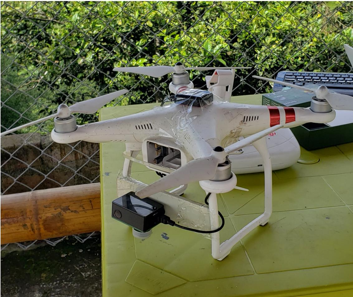
Figura 3.8: Montaje cámara Survey 3W y Phantom 3 Standard. Fuente: propia
