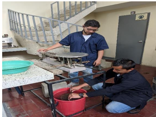
Ilustración 8 Ensayo de gravedad específica al agregado grueso.
