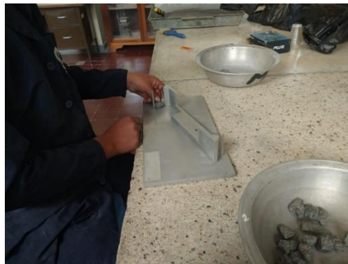
Ilustración 9 Realización del ensayo de Índice de alargamiento y aplanamiento.
