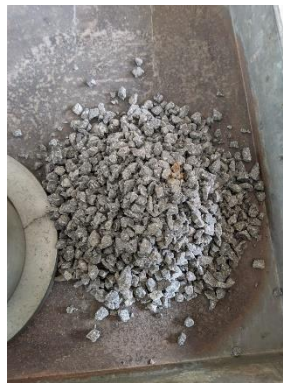
Ilustración 11 Realización del ensayo de 10% finos
