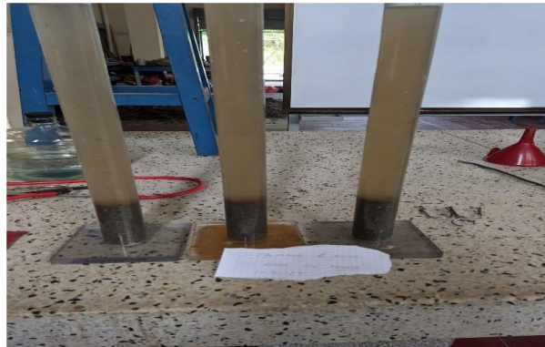
Ilustración 14 Probetas de ensayo de equivalente de arena para agregado de aporte.
