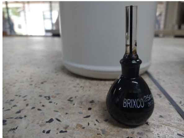
Ilustración 15 Ensayo densidad y densidad relativa de materiales bituminosos
