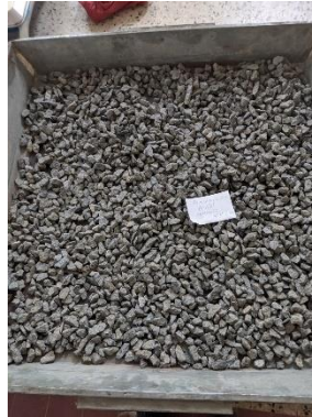
Ilustración 10 Realización del ensayo partículas fracturadas
