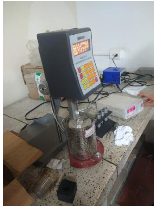
Ilustración 17 Ensayo viscosímetro Brookfield
