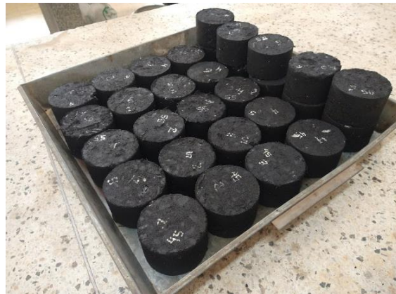
Ilustración 19 Briquetas Marshall modificado
