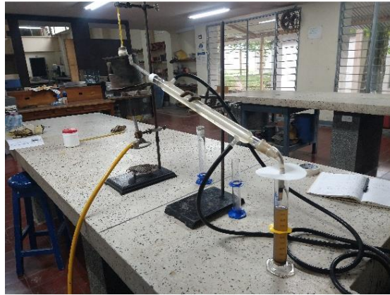
Ilustración 16 Montaje y proceso de destilación de asfalto líquido.
