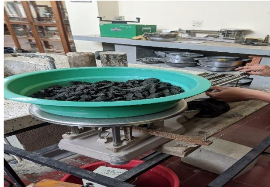
Ilustración 7 Ensayo de gravedad específica al agregado grueso
