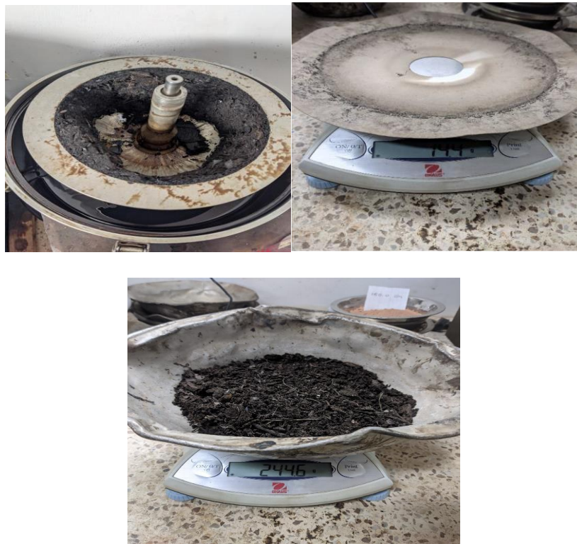
Ilustración 18 Ensayo de extracción realizada a la primera muestra.
