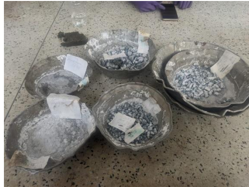
Ilustración 6 Ensayo de granulometría del agregado de aporte
