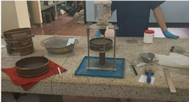
Ilustración 13- Ensayo de angularidad de la fracción fina del material de aporte
