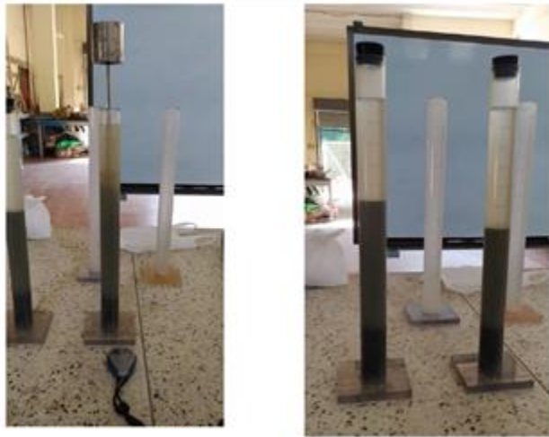
Ilustración 9- Ensayo de equivalente de arena para agregado de aporte
