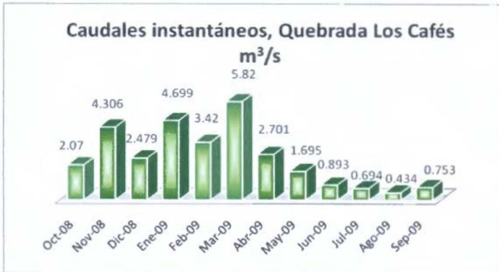
En la quebrada Los Cafés, se consideró una longitud de 210.46 m aguas arriba de la desembocadura en el río Ovejas; en este tramo también se realizó un levantamiento topográfico donde se trazaron secciones transversales de longitudes variables. Los caudales instantáneos se midieron con molinete debido a que el nivel del agua de la quebrada lo permitía.
