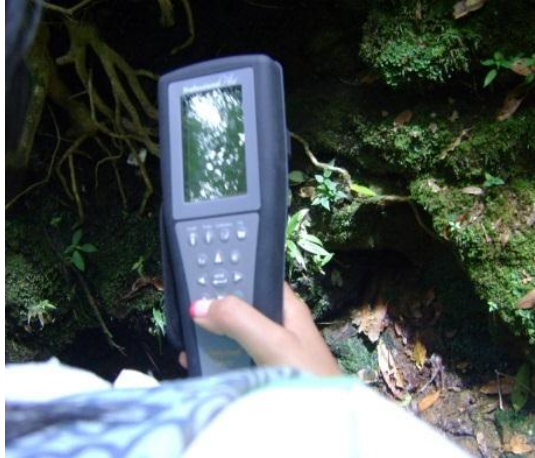
Figura 8. Análisis fisicoquímico con la sonda portátil multiparamétrica – YSI.
