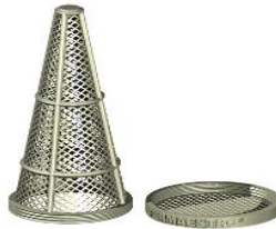
Figura 42. Fermaestro empleado para verificar el proceso de desmucilaginado del café
