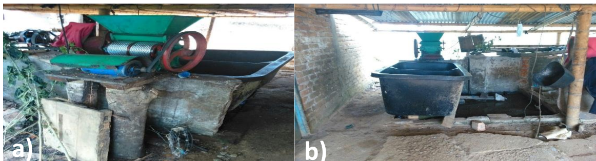
a) Despulpadora 2 chorros tipa A, b) tanques de fermentación y lavado
