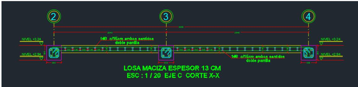
Ilustración 29 Corte losa de entrepiso.
