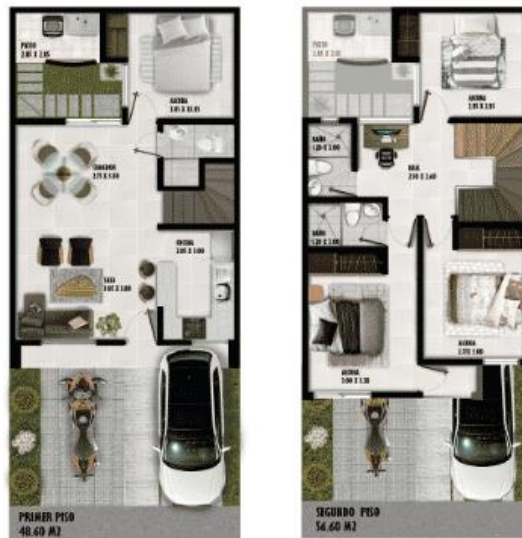
Imagen 4. Planta primer y segundo piso casa tipo 1.
