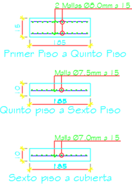
Imagen 19. Vista en planta muro estructural eje T.
